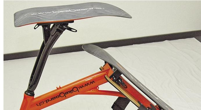
**9.** Achten Sie beim Anziehen der Schnellspanner darauf, dass die „Kralle“ und der Rahmen gut zusammen gepresst werden. Schnellspanner vorne nach vorne richten, damit man gut zum Sicherungsknopf gelangt.
