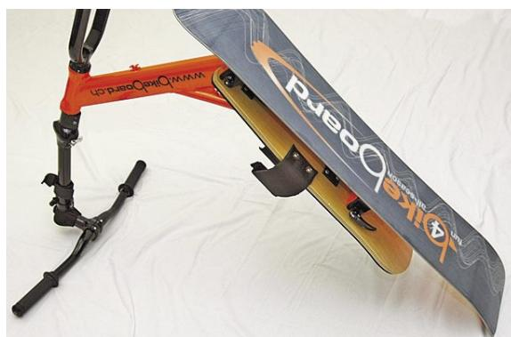
**8.** Hinteres Snowboard zuerst mit unterer „Kralle“ in Rahmen einführen. Anschliessend Snowboard nach vorne drücken und obere „Kralle“ in den Rahmen schieben.
