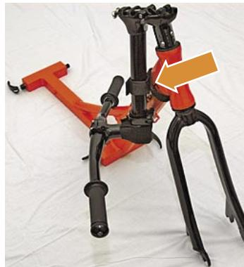
**1.** Kurzer Schnellspanner mit den beiden Federn bestücken (liegen separat bei). Griff des Schnellspanners nach hinten ausrichten – Sicherungsknopf lässt sich so bequem betätigen.
